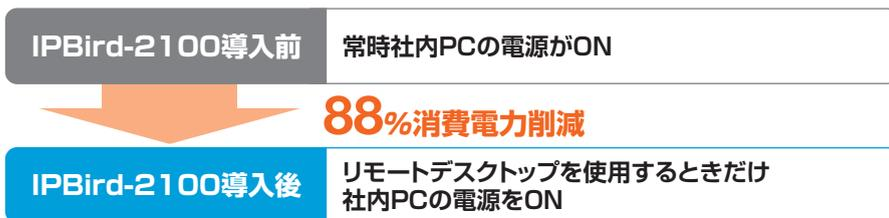
消費電力は、以下の仮定で計算しました。(PC1台の消費電力180W/H、IPBird-2100の消費電力1.7W/H)
